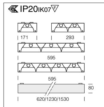
**Оптическая система:** из матированного алюминия, с рифленной поперечной решеткой с широким светораспределением.
